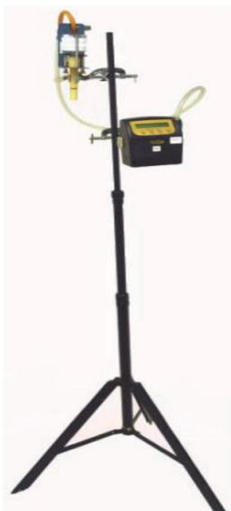
**Figura 2.** Coleta de amostra estacionária (de área ou de ponto fixo).
